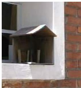
Foto 4 Caseta para discos de corrosividad
